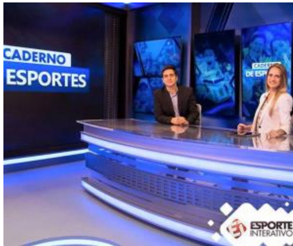
6 - Sistema instalado no Esporte Interativo com 10 monitores de Vídeo Wall Full HD - Ao vivo + Png Alpha Channel e Painel de Led.
