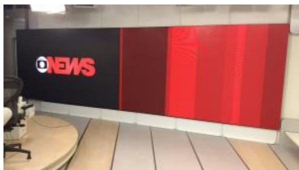
5 - Sistema instalado na Globo News com 2 entradas de vídeo Full HD - Ao vivo + Sequência de Png Alpha Channel.
