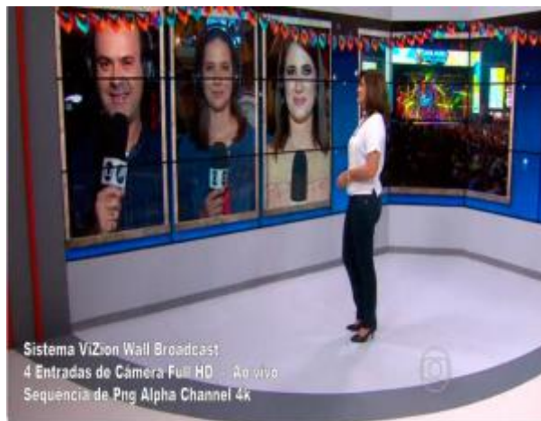
4 - O sistema ViZion Wall Broadcast instalado na Globo de Recife consiste em 27 monitores de videowall, formando uma grande tela. Foram utilizadas 4 entradas de vídeo em Full HD, e Png Alpha Channel 4k.
